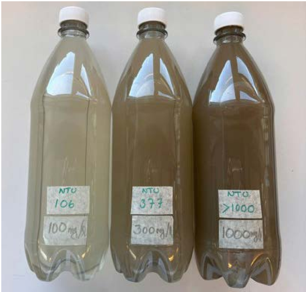
Kuva 17. Kiintoainepitoisuudeltaan ja sameudeltaan erilaisia vesiä muovipulloissa. Pulloihin on merkattu veden kiintoainepitoisuus yksikössä mg/l ja sameus yksikössä NTU. Turun ammattikorkeakoulu
